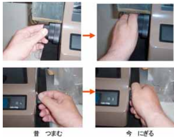
図8 安全ピペッターの着脱。ガラスとゴムの微妙な組み合わせをどう扱うか分からない。下が安全なやり方。
