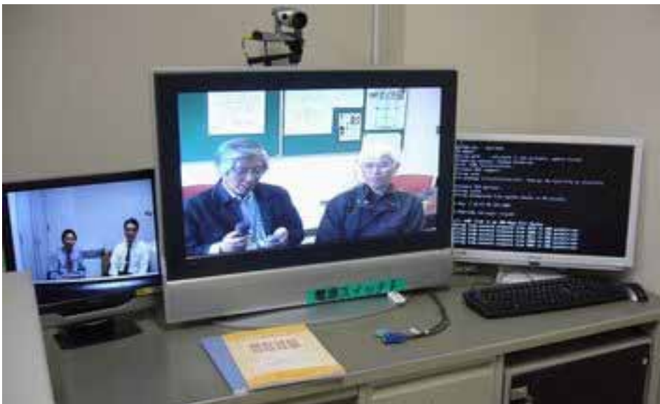
図1 . 工学教育研究センターと工学部サロンを結ぶTV会議システム 左端のモニタが自局の画面、中央が相手局の画面、右端がパソコンの画面(資料提示が可能、マニュアルを参照下さい)。
